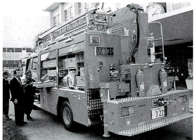
(排気量8200cc。全長7.48m 全幅2.3m 全高3.25m。220馬力)
