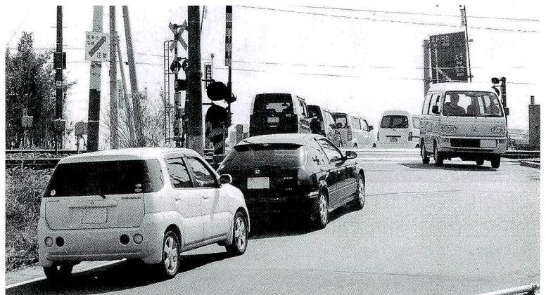
踏切を頂点にした坂道のため見通しが悪かった
