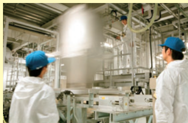
コンテナから原料を投入しているところ
