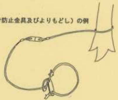
よりもどし 金具の両端が回転することができる構造
