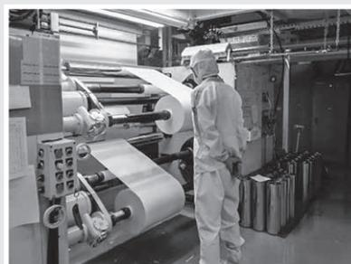
基材に接着剤を塗工し、ラミネートする工程
