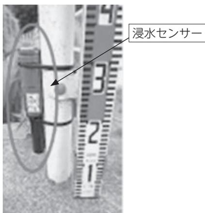
ガードレールの支柱に取付けた浸水センサー
